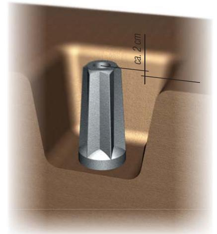
3. Grube mit Aushubmaterial auffüllen. Rohrsteher in den Fundamentsockel stellen und mit Sicherungshülse fixieren (Sicherungshülse einschlagen bis Steher festgeklemmt ist).
