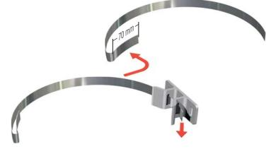
2. Stahlband durch die Schlitze der NB-Lasche ziehen und um den Rohrsteher legen.
