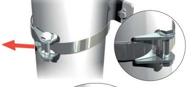
5 Spannschraube mit Ringschlüssel drehen bis das Stahlband gespannt ist. Spannschraube mit Mutter sichern.
